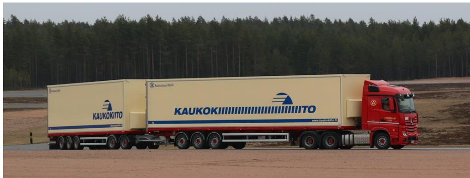
Kuva 15. Auramaan HCT-ajoneuvo on 33,78 metriä pitkä ja sen kokonaispaino saa olla enintään 75 tonnia (Trafi 2018).
