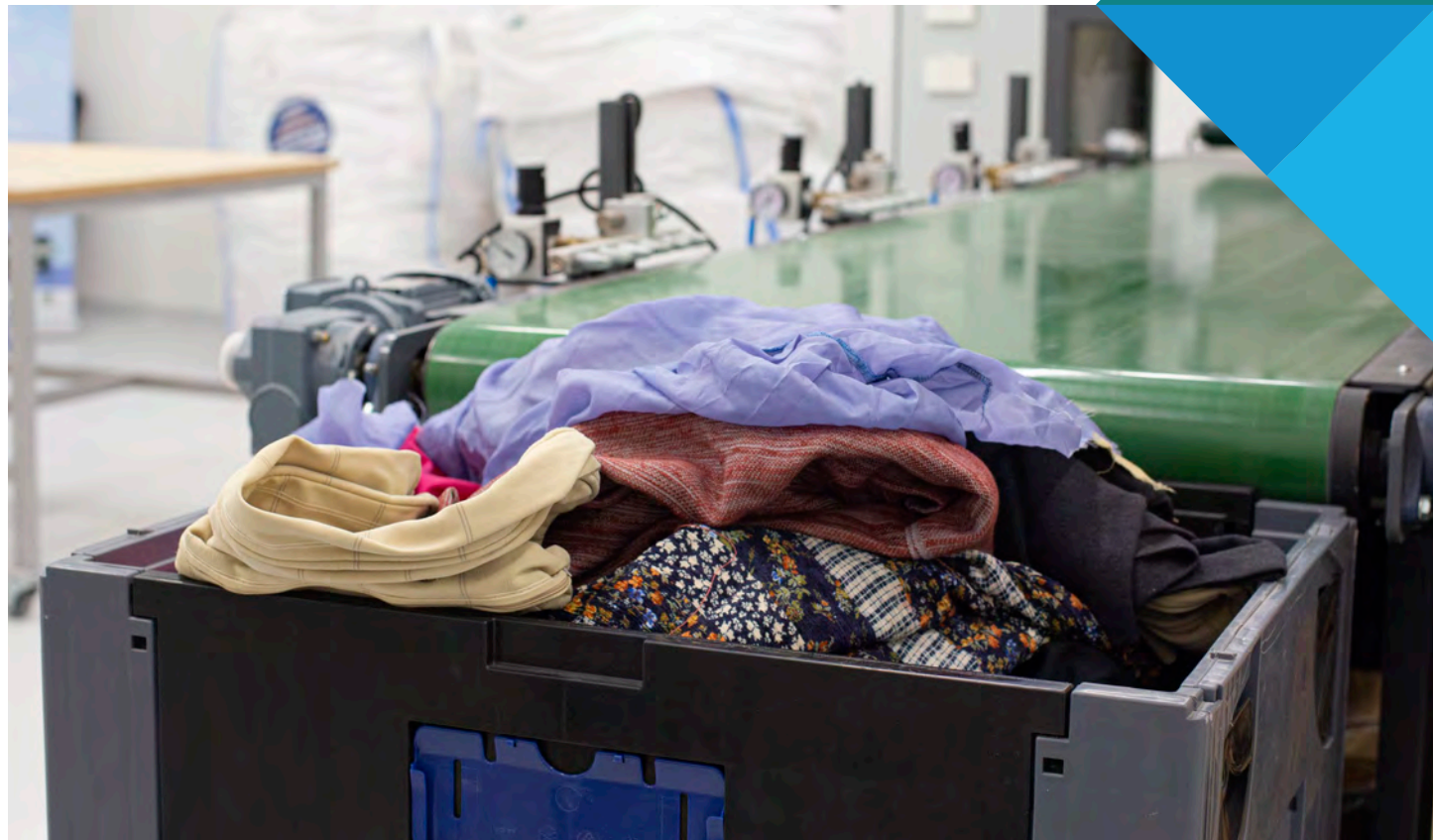
LABin optiseen tunnistukseen perustuvalla lajittelulinjastolla erilaiset tekstiilimateriaalit saadaan eroteltua. Kuva: Sanna Henttonen
