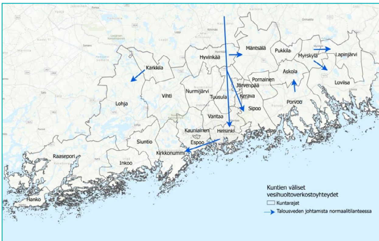
KUVA 23. Uudenmaan vesihuoltolaitosten väliset keskeisimmät vesijohtoverkostoyhteydet normaalitilanteessa (Lähde: Etelä-Savon elinkeino-, liikenne- ja ympäristökeskus, 2023).
